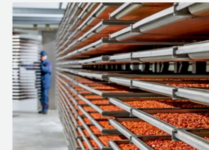
Einblick in die Produktion: Gefrier-trocknungsbleche und Abfüllung in Glasbehälter.
