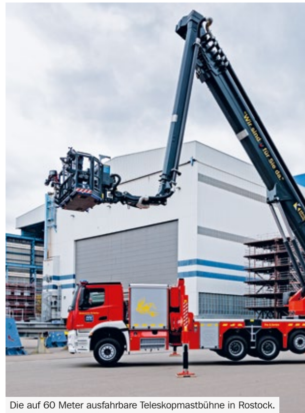
Die auf 60 Meter ausfahrbare Teleskopmastbühne in Rostock.
